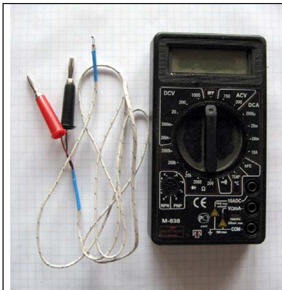
Рис. 13. Мультиметр цифровой M838 и термопара К – типа (хромель – алюмель).
