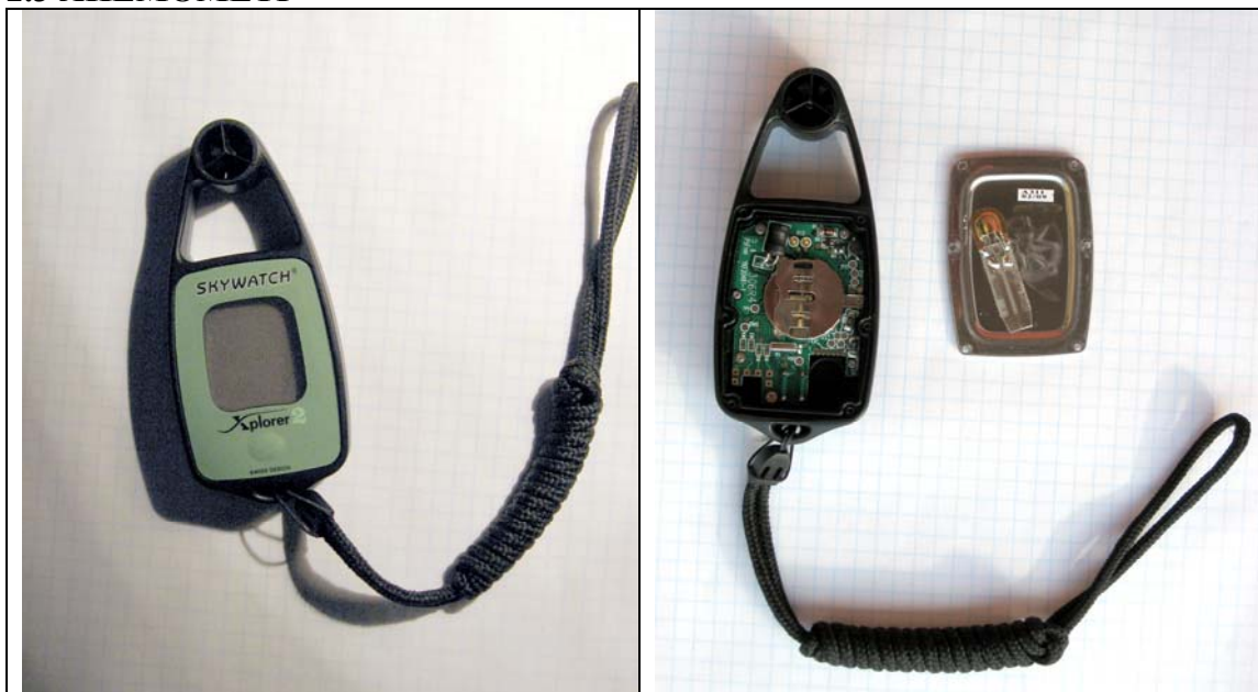
Рис. 14. Анемометр Skywatch Xplorer 2. На задней металлической крышке прибора видно приклеенное термосопротивление.
